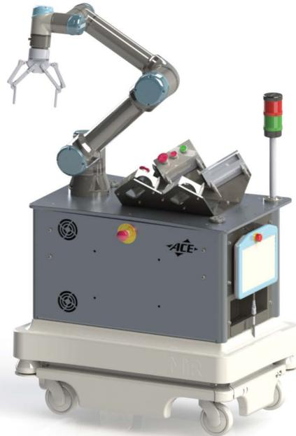
Bediener oder Fahrer auf dem Boden einer Anlage bewegen und von einer Kombination aus Software und sensorbasierten Leitsystemen geführt werden. FTS sorgen für den sicheren Transport von Fracht, indem sie einem vorhersehbaren Kurs folgen. Beide können beim Navigieren in ihrer Umgebung auf ein unerwartetes Hindernis stoßen, z. B. auf eine heruntergefallene Kiste oder eine Menschenmenge.
