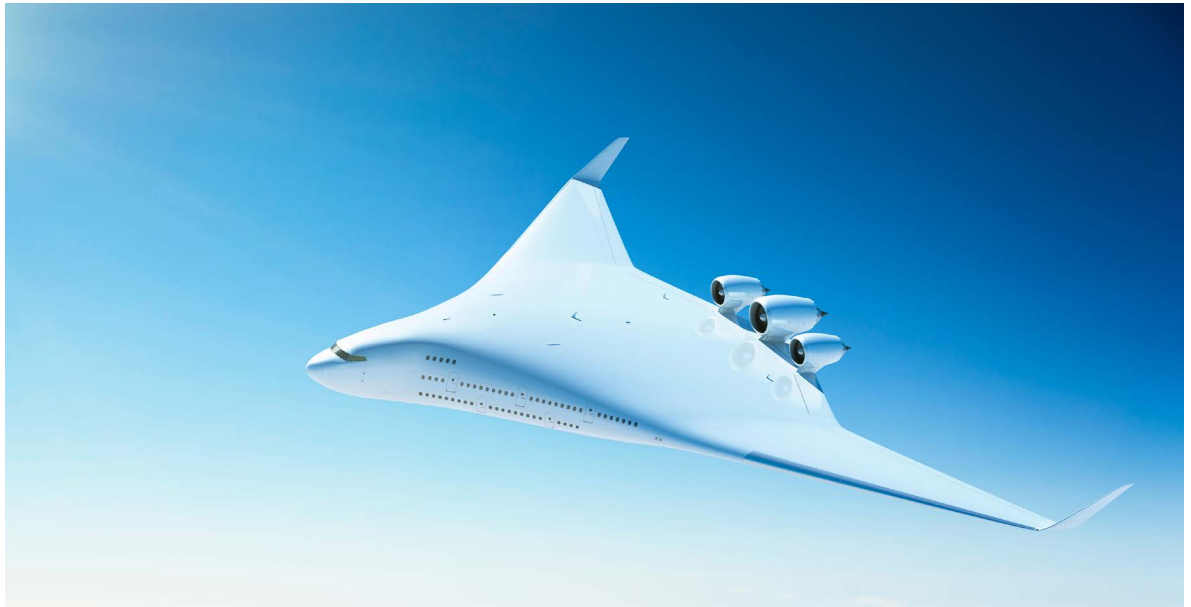
Schéma 2 : L'espace accru dans le fuselage des avions à fuselage intégré peut être utilisé pour stocker des batteries et de l'hydrogène, ou de l'hydrogène et des piles à combustible, sans sacrifier la capacité en passagers ou en fret.
