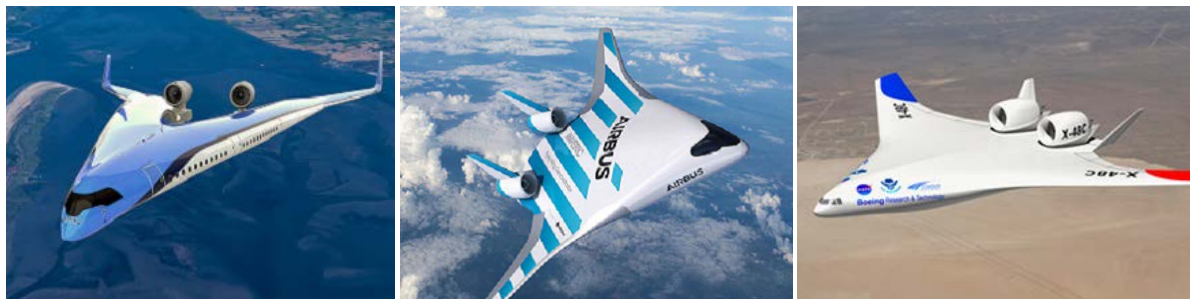
Schéma 14 : Démonstrations à l'échelle de TUDelft Flying V (TUDelft), Airbus Maveric (Les Echos) et Boeing X 48C. (defenceWeb)
