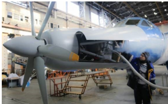
Schéma 13 : Banc d'essai volant de propulsion électrique supraconductrice (Sibnia, SuperOx), concepts de turbosoufflante refroidie à l'hydrogène. (IEEE Electrification Magazine.)
