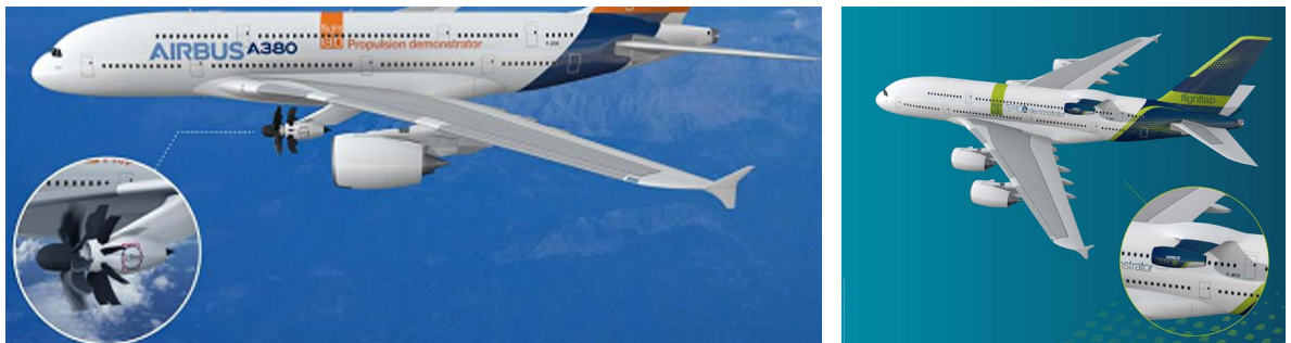
Schéma 28 : Laboratoires de vol de l'Airbus A380 pour les démonstrateurs OpenFan et de combustion d'hydrogène. (Airbus)
