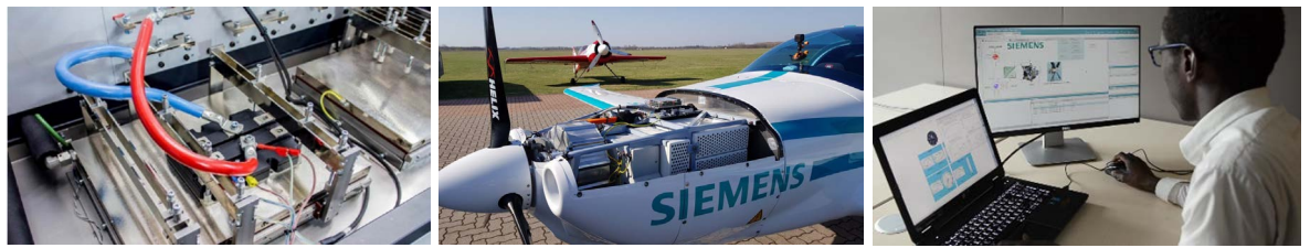
Schéma 26 : Essais de propulsion électrique à l'aide du testeur thermique transitoire non destructif Simcenter Micred T3STER (à gauche) jusqu'à l'acquisition Simcenter SCADAS à l'échelle de l'avion (au milieu) et aux essais en vol virtuels dans Simcenter Amesim.
